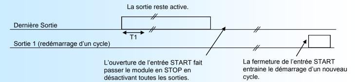
Ce mode permet, par exemple, de cascader des modules SEQ165. La dernière sortie du module est connectée à l'entrée START du suivant.
