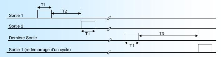
T1 : Durée de l'impulsion de sortie (réglable de 0.01s à 5.00s par pas de 0.01s)
